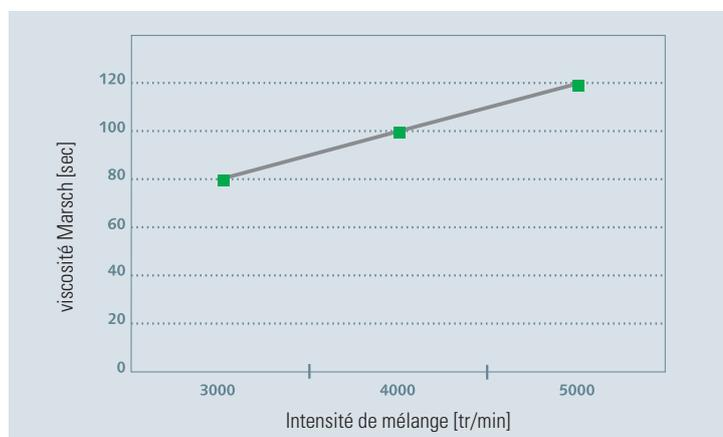
Viscosité ThermoCem *PLUS* suivant l'intensité de préparation (durée de préparation : 2 min.)
