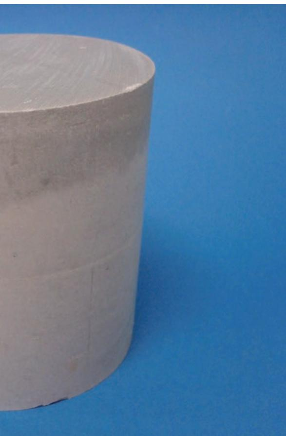
Les éprouvettes sont stockées en ambiance humide. La base des échantillons est baignée en permanence dans l'eau afin de simuler la pénétration d'eaux souterraines dans la zone soumise aux cycles de gel-dégel autour des sondes géothermiques.
